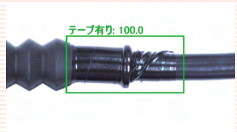
EasyInspector2 同系色のワークから対象物だけを 検出する例
