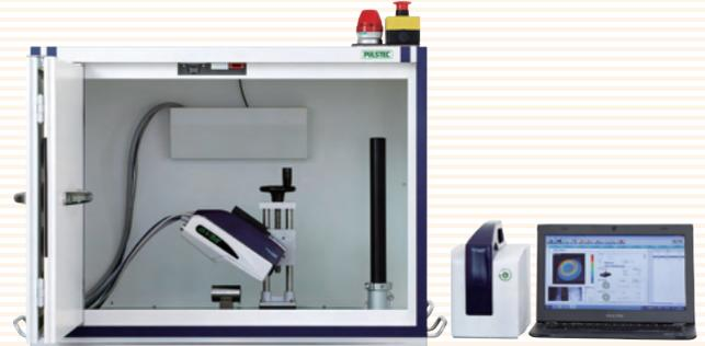
ポータブル型残留応力測定装置
